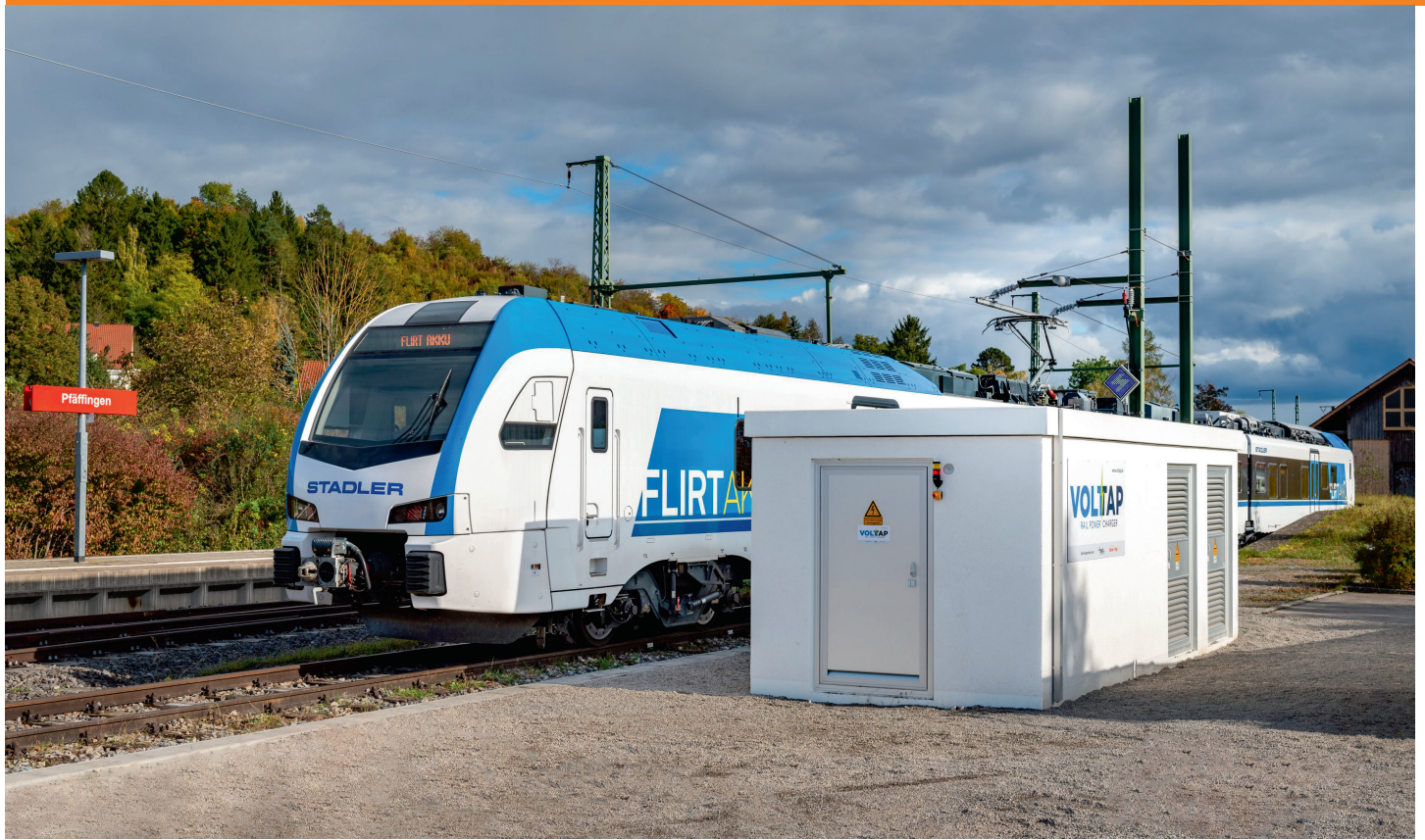
Prototyp der Voltap-Schnellladestation für Batteriezüge.
