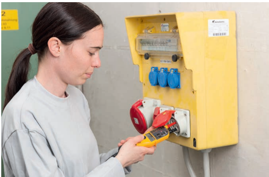
Figure 4 Mesure sur une prise de courant IP2X sans EPI.
