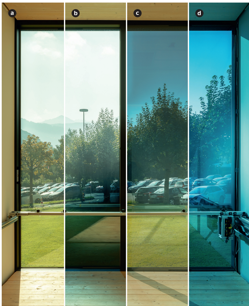
Figure 2 La fenêtre du container de mesure de la lumière de la HSLU avec quatre réglages différents des verres électrochromes : (a) non teinté, (b) dégradé continu du haut non teinté au bas teinté, (c) dégradé continu du haut teinté au bas non teinté et (d) teinté.
