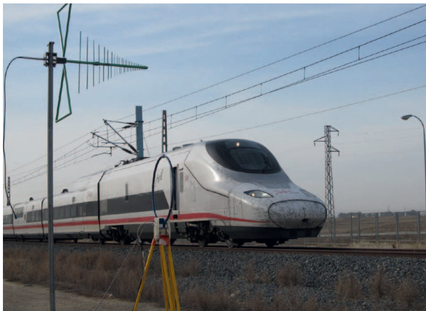
Figure 4 Mesures des émissions rayonnées d'un train Talgo.
